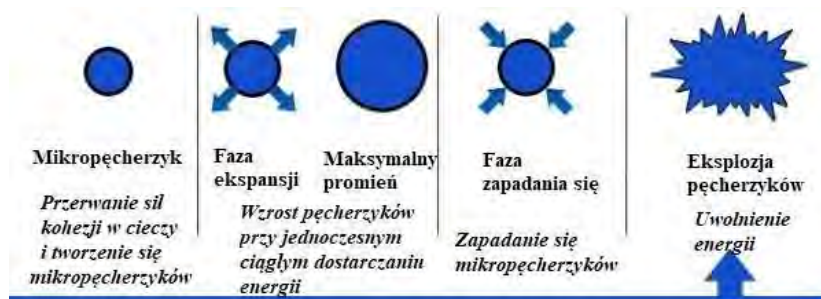
Rys. 5. Schemat powstawania mikropęcherzyków podczas procesu kawitacji ( http://www.cavimax.co.uk/what-does-cavimax%C2%AE-do )
