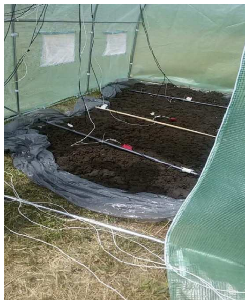
Rys.2. Suszenie osadu w warunkach półtechnicznych
