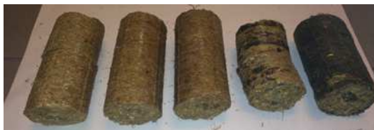
Rys.4. Wytworzone brykiety o różnych proporcjach składników.
