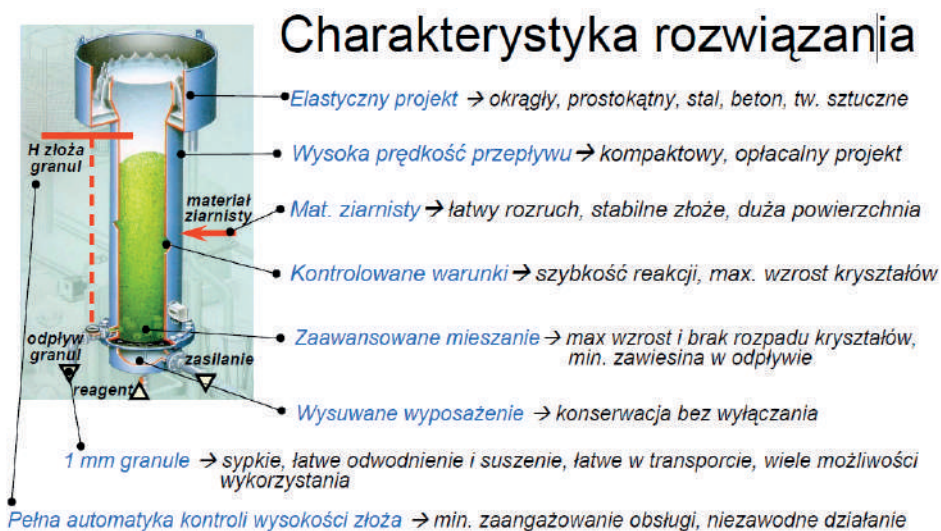
Rys.22.5. Podstawowa charakterystyka technologii Crystalactor [1]
